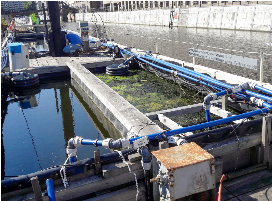
Abb. 1. Sicht auf die Filterbecken 1 und 2 der Testfilteranlage des Flussbades Berlin e.V. Digitalfotografie: Tülin Fidan, 2020.
