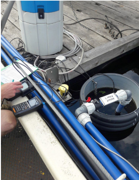
Abb. 3. Multiparametersonde im Einsatz im Ablauf von Filter 1, Digitalfotografie: Tülin Fidan, 2020
